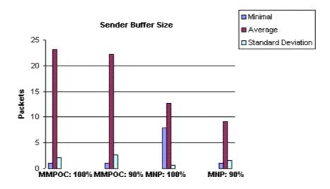
Figure 15 - Buffer reduction using split consecutive connections / Réduction de l'utilisation des tampons avec des connexions partagées
