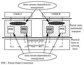
Figure 7 - Architecture of a partial order transport / Arcitecture d'un transport à ordre partiel
