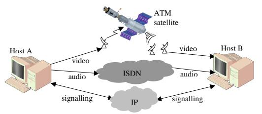
Figure 1 – Parallel multi-networking / Multi-réseau parallèle
