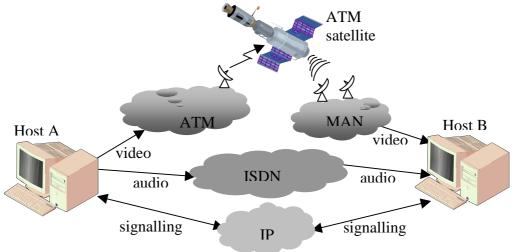
Figure 3 - Parallel & Serial Multi-networking / Multi-réseau série et parallèle
