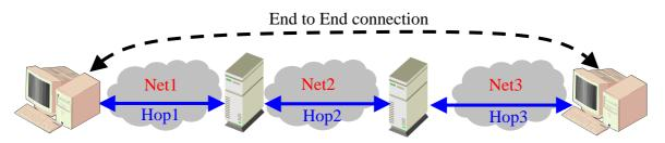
Figure 9 – Serial multi-networking configuration / Configuration pour le multi-réseau série
