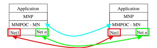
Figure 4 – MNP architecture for parallel multi-networking / L'architecture MNP pour le multi-réseau parallèle
