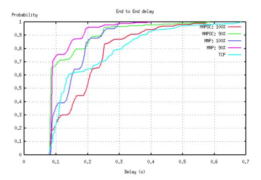
Figure 14 - End to end delay reduction using split consecutive connections / Réduction du délai de bout en bout lorsque les connexions sont partagées
